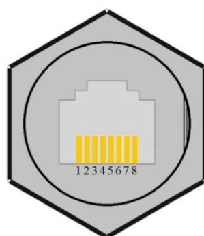
شکل ۳-۶: آرایش پین‌ها در کانکتورهای RJ45 دستگاه
